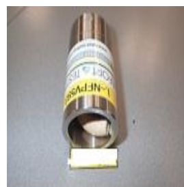
Gebroken ring in testcilinder.jpg
